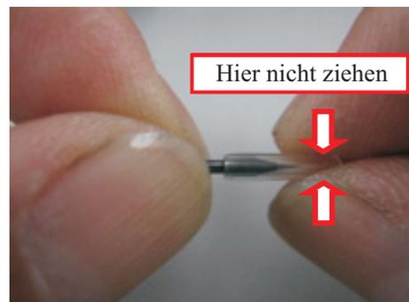
(2) Die Messerspitze kann etwas festkleben. Durch die Drehbewegung kann die Messerspitze brechen.
